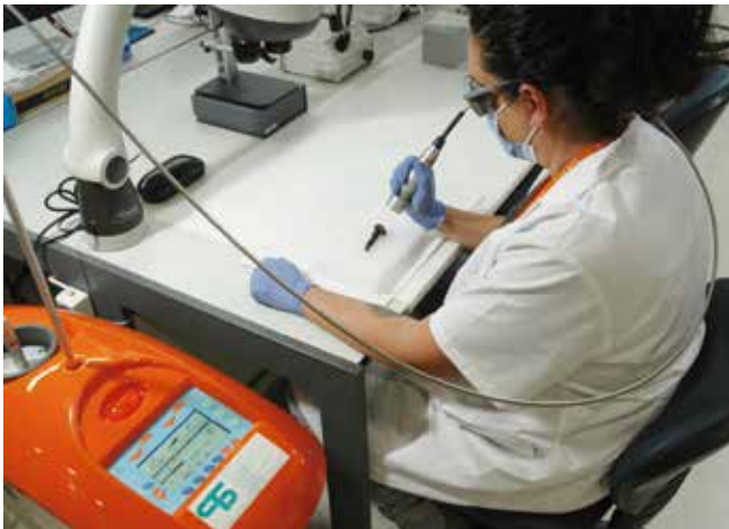
Figura 3: Proceso de limpieza láser en el Laboratorio de Restauración de un clavo de hierro del yacimiento Durdur (Aspe). Taller de Restauración. Archivo Gráfico MARQ.
