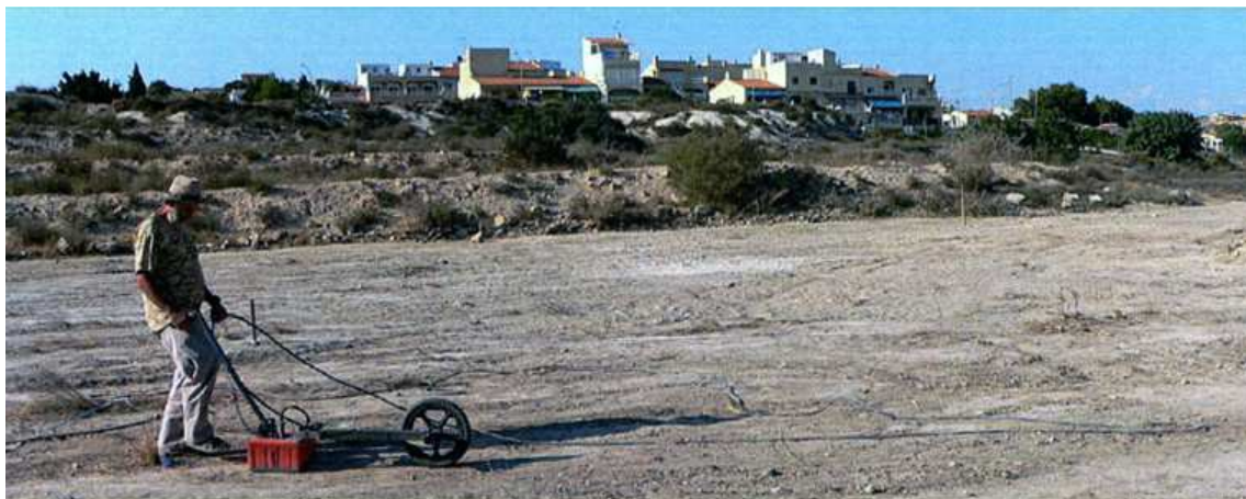
Adquisición de un perfil radar con la antena 400 MHz y su rueda marcadora de distancia, odómetro, que permite el disparo automático a distancias muy precisas
