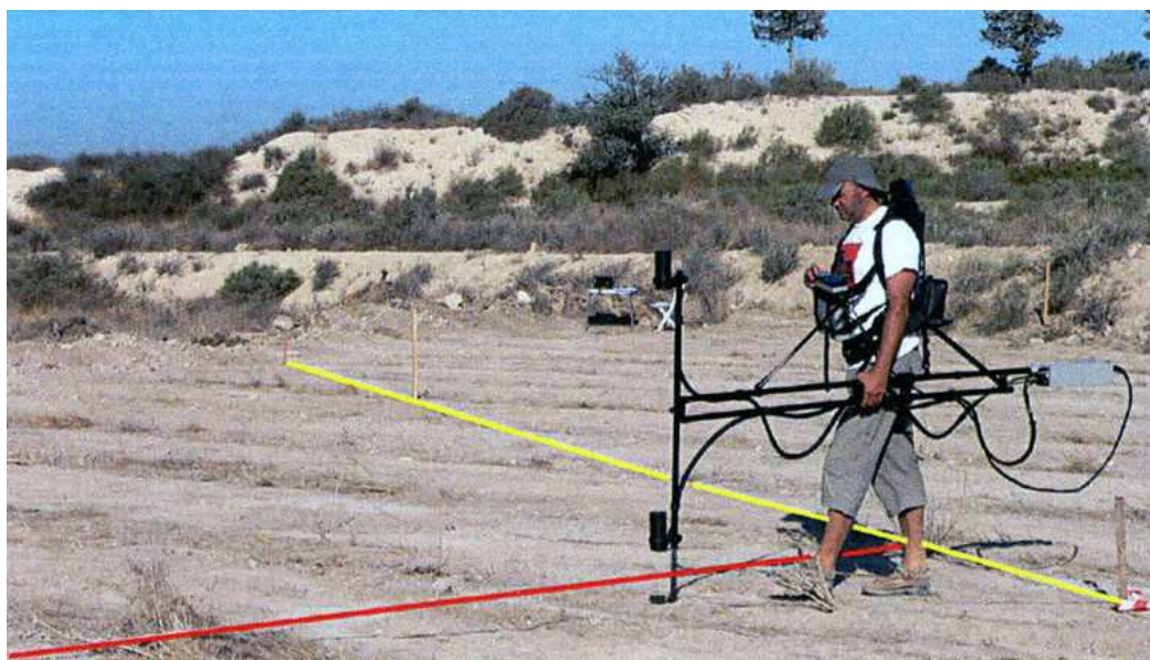
Magnetómetro usado en las prospecciones. En la foto se está realizando un perfil que se materializa siguiendo un hilo que une dos cintas métricas colocadas en los bordes del sector estudiado
