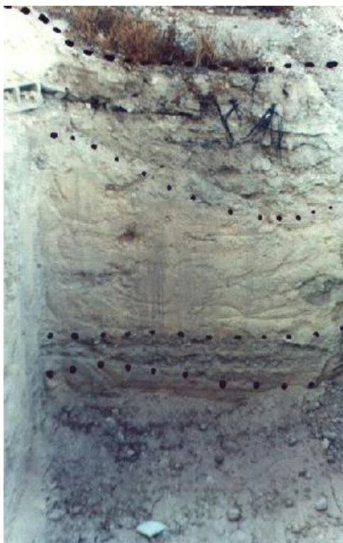
Cata destinada a fosa séptica. Secuencia de estratos
